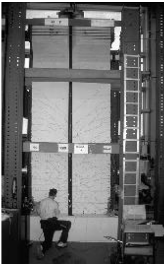
6. Laborversuche zur Untersuchung des Erdbebenverhaltens einer Stahlbetontragwand an der ETH Zürich
